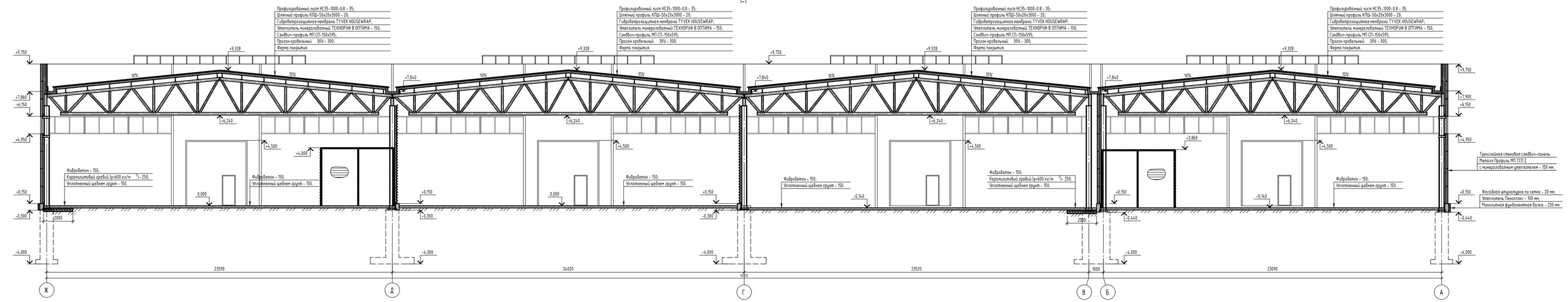
1. За относительную отметку 0,000 принят уровень чистого пола склада, соответствующий абсолютной отметке 163,940.
